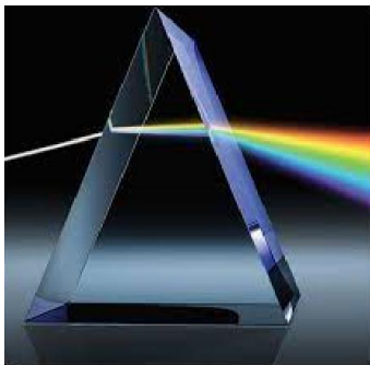
Slika 3 - Optična prizma žarek bele svetlobe loči v tiste barve svetlobe, ki so vsebovane v žarku.
